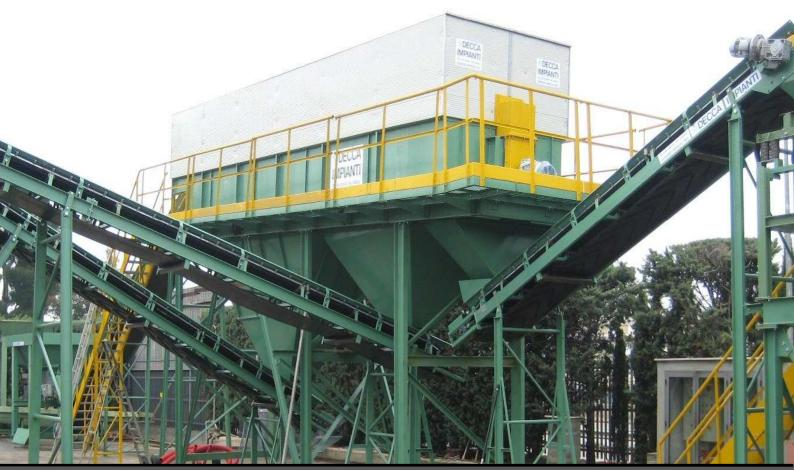
FOR THE SELECTION AND THE RECOVERY OF FERROUS AND NON-FERROUS METALS
